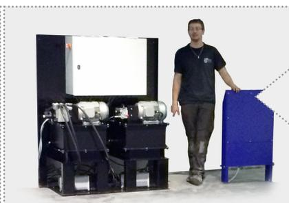
Groupe hydraulique avec automate programmable et panneau de commande commun L'opérateur actionne les pênes de verrouillage, fait monter et descendre les tables élévatrices et effectue une rotation des axes d'essieu en toute sécurité et en toute simplicité. Les voyants LED sur le panneau de commande permettent de signaler tout problème éventuel.
